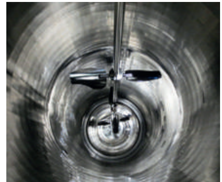
Abb. 4: Reaktionsbehälter nach dem Derouging
